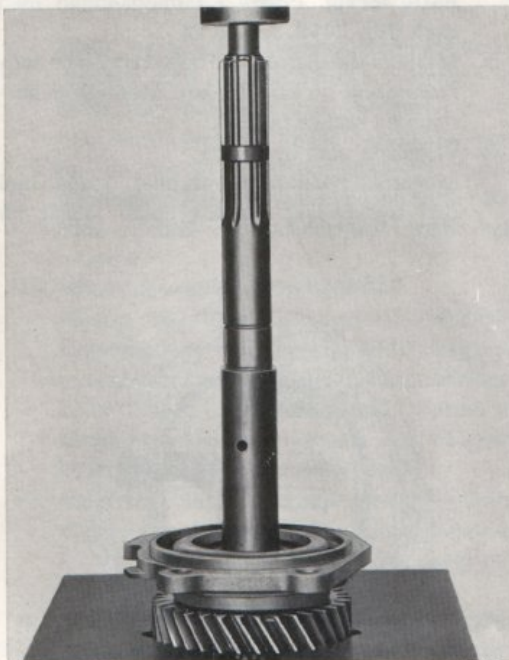
Bild 20. Isärtagning av huvudaxel, M 41.
